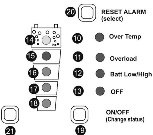
LED 13 (ON/OFF) : Seuil de sous-tension de batterie
